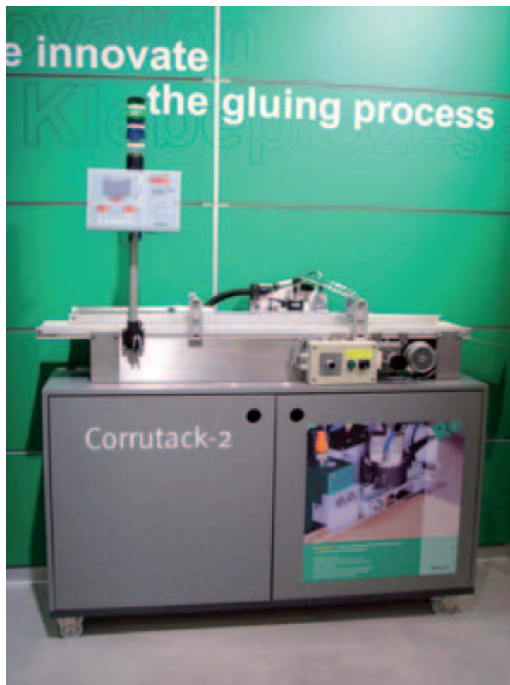
Sauber und sicher verleiht das bedienerfreundliche Corrutack-2-System für Wellpappezuschnitte – selbst dann, wenn diese gebogen sind. Bild: Robatech
